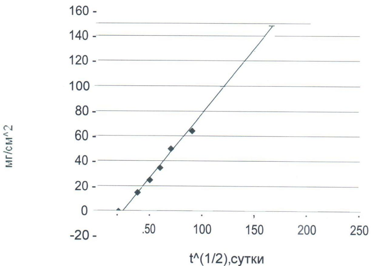
**Рисунок 1** Извлечение гидроксида кальция в пересчете на CaO из бетона с покрытием
